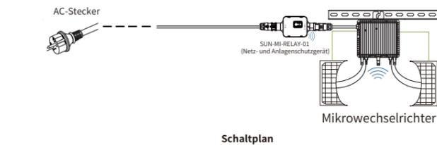
Bitte schalten Sie vor der Installation den Gleich- und Wechselrichter (AC und DC) des Mikrowechselrichters aus, warten Sie 5 Minuten und beginnen dann mit der Inbetriebnahme.
