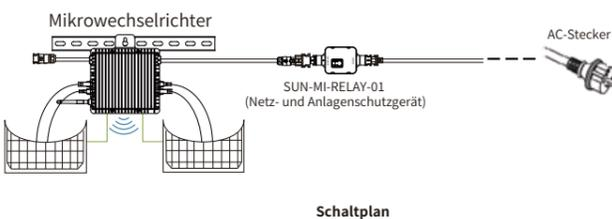
Bitte schalten Sie vor der Installation den Gleich- und Wechselrichter (AC und DC) des Mikrowechselrichters aus, warten Sie 5 Minuten und beginnen dann mit der Inbetriebnahme.
